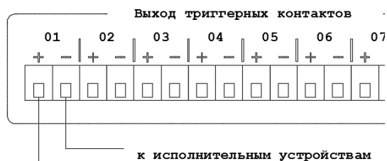
Рис. 3.5. Схема подключения внешних исполнительных устройств к LPA-PRESTA-2.
